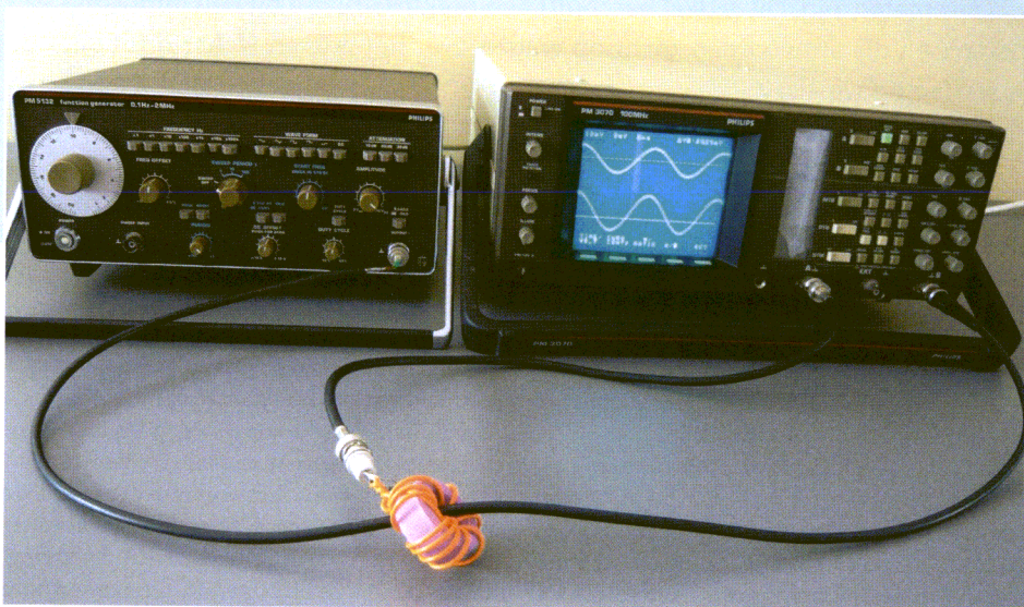
Figuur 2: In deze opstelling zijn de binnengeleider en mantel van een coaxiale kabel aan één zijde kortgesloten en verbonden met de binnengeleider van een BNC-connector. Deze kant wordt aangesloten op een functiegenerator. Ondanks de kortsluiting meten we een spanning op de oscilloscoop.
