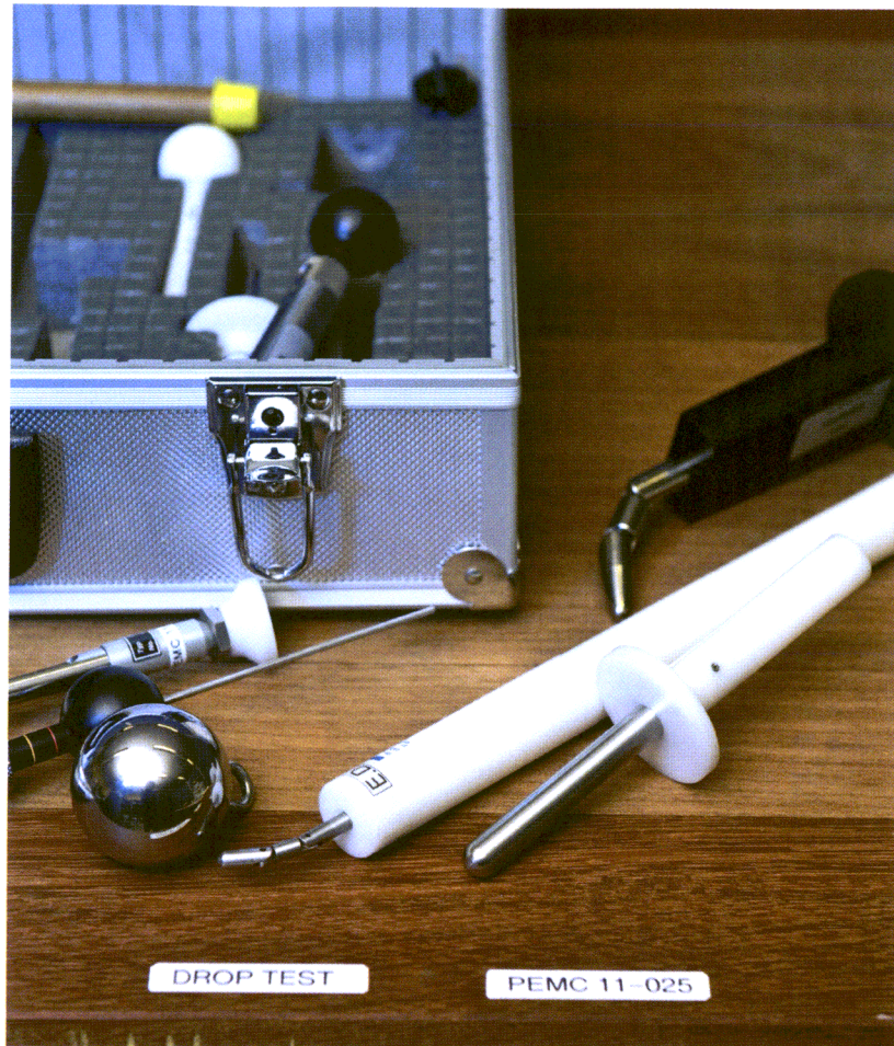
Een LVD-test verifieert onder meer of er geen vingers aan gevaarlijke componenten kunnen, eventueel na beschadiging van de behuizing.
